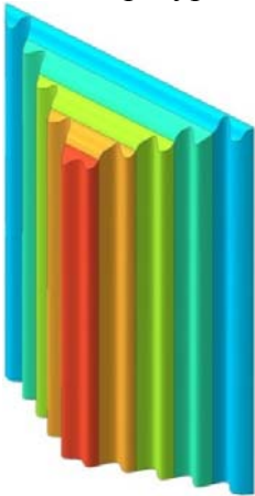
Рис. 4 – Трехмерная модель теплового поля воздуха
